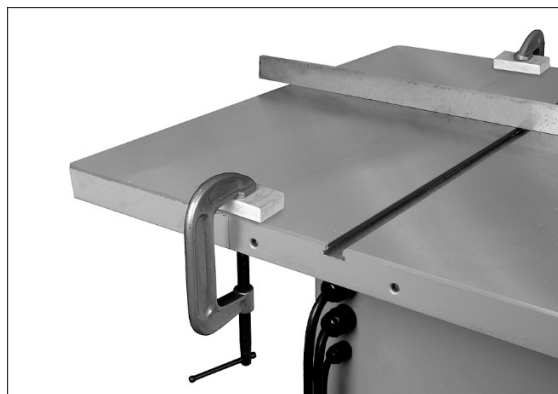
Рис. 6-5: Выравнивание удлинений стола, способ 2
