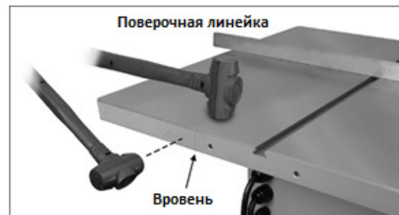
Рис. 6-4: Выравнивание удлинений стола, способ 1
