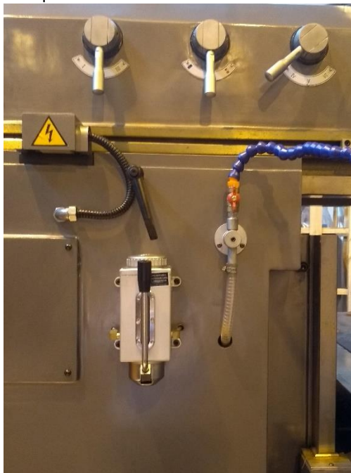
Рис. 17 Насос смазки стола
